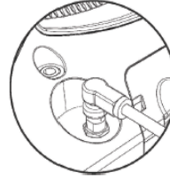
Připojení napájecího kabelu
